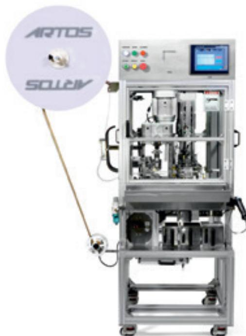
встроенные средства контроля качества. SSC-500 проводит предварительную проверку концов проводов, не используя срезы; устройство контроля силы обжатия (CFM) проверяет каждый обжим на наличие дефектов. Кроме того, лазерный датчик цвета изоляции обеспечивает установку правильного провода. Встроенная светодиодная лампа обеспечивает максимальную видимость.
